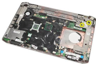
13. モデムカードを持ち上げ、カード背面のコネクターから取り外した後、コンピューターから取り外します。
