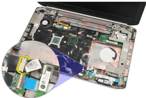
10. Bluetooth カードを固定しているネジを外します。
