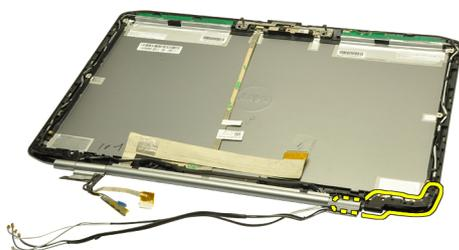
15. 右側の穴から右ヒンジタワーに配線しているアンテナケーブルを引き抜きます。
