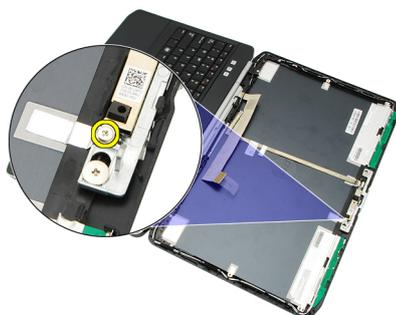
7. カメラモジュールを持ち上げて、取り外します。
