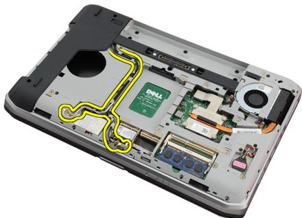
12. LVDS（低電圧差動信号）ケーブルを取り外します。
