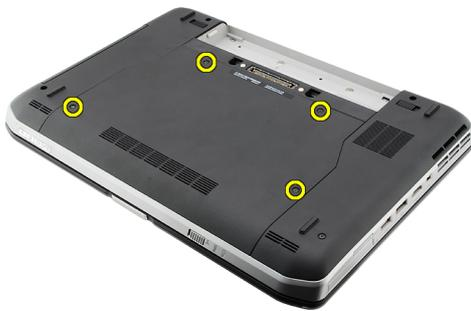
4. 背面パネルをコンピューターの前面に向かってスライドさせて、取り外します。
