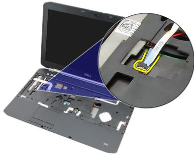
11. 電源 LED ケーブルを取り外します。
