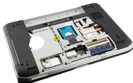
5. スクリュータブを押しながらコンピューターから外し、オプティカルドライブをドライブベイから解除します。
