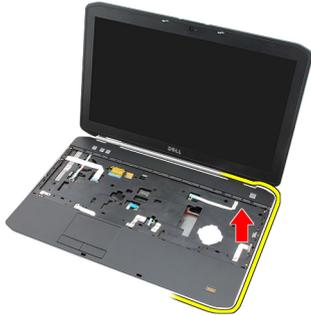
16. パームレストアセンブリの左端のタブを解除し、パームレストを取り外します。
