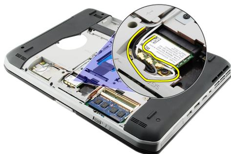
5. WLAN カードをシステム基板に固定しているネジを外します。
