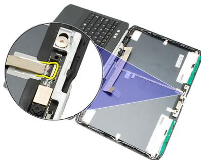
6. カメラとマイクモジュールを固定するネジを緩めます。
