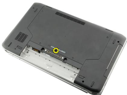
5. コンピューターを裏返し、コンピューターの前面にキーボードを固定しているネジを外します。
