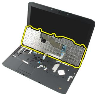
10. キーボードデータケーブルの接続を切り、コンピューターから取り外します。
