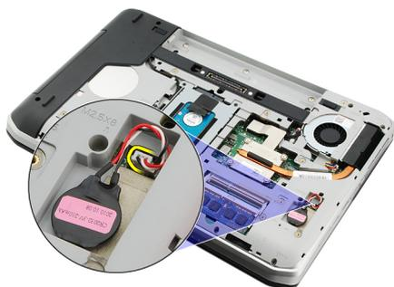
6. コイン型電池をてこの作用で開け、接着剤から取り外します。
