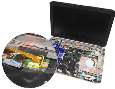
14. コンピューターのトップにある穴からアンテナケーブルを引き抜きます。
