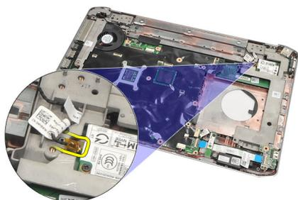
16. 配線チャンネルからモデムケーブルを取り外します。
