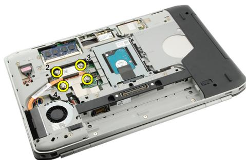
6. ヒートシンクを持ち上げ、コンピューターを取り外します。
