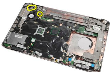
18. 左のサポートブラケットをモデムケーブルに沿ってスライドさせ、コンピューターから取り外します。
