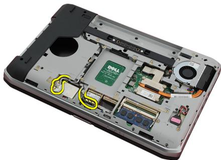
11. 配線チャンネルからアンテナケーブルを取り外します。
