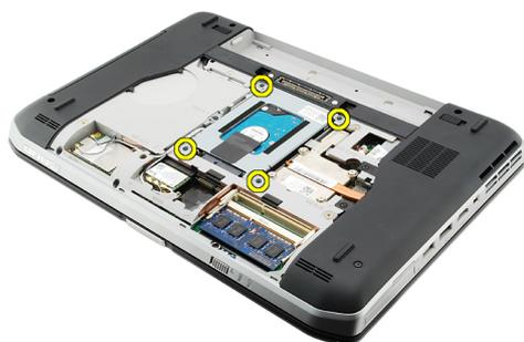
5. タブを使ってハードドライブブラケットを引っ張り上げ、コンピューターから取り出します。
